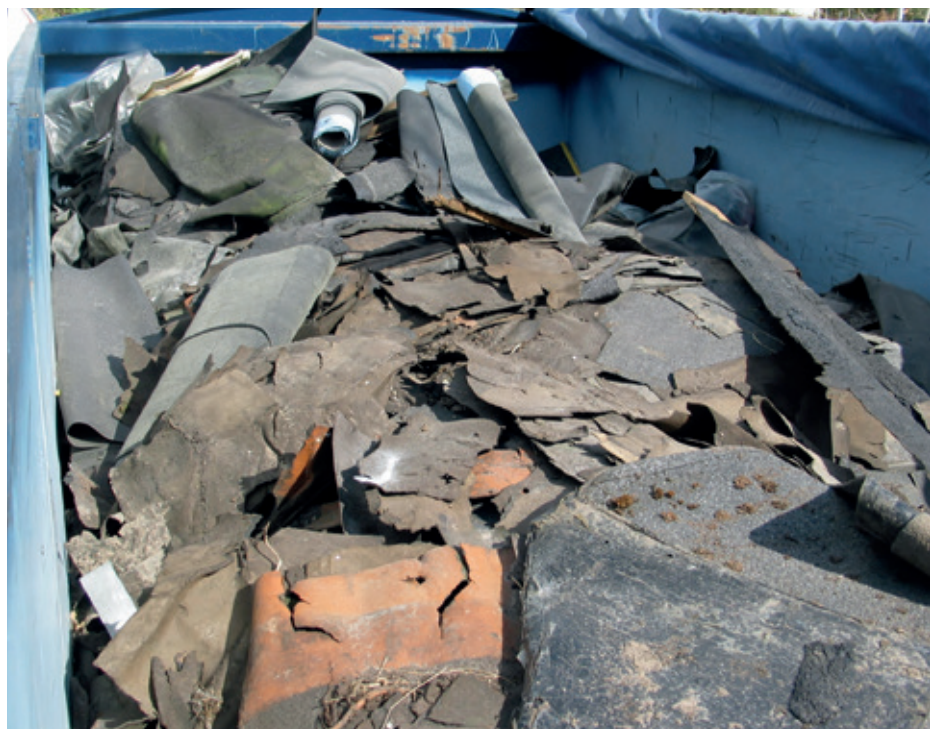
Tagpapaffald. Ældre typer af tagpap kan indeholde stenkulstjære og asbest. Det tilrådes at tage kontakt med modtageren og få information om, hvilke typer, der kan modtages.
