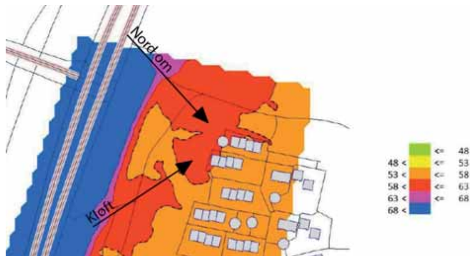
Nuværende støjdbredelse. Den røde farve indikerer areal med for høj støjbelastning.
